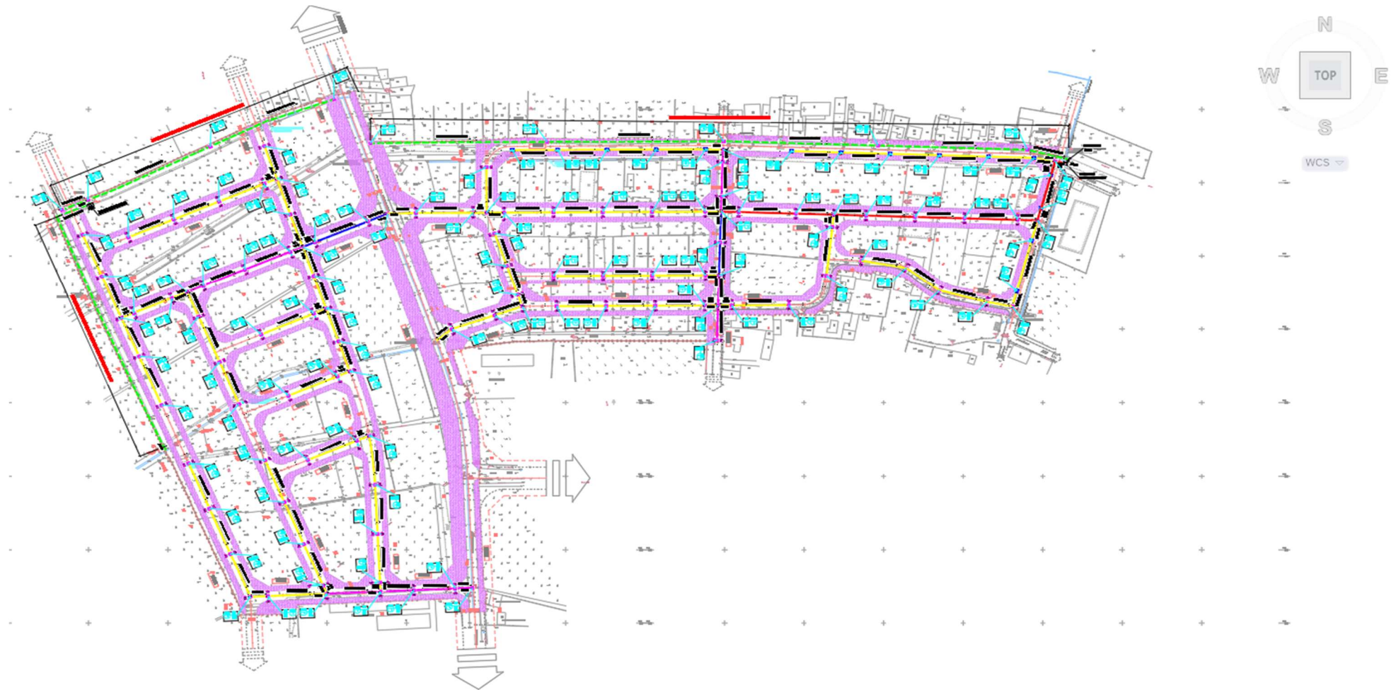
Hình 4. 7: Sơ đồ thu gom, tiêu thoát nước mưa của dự án
